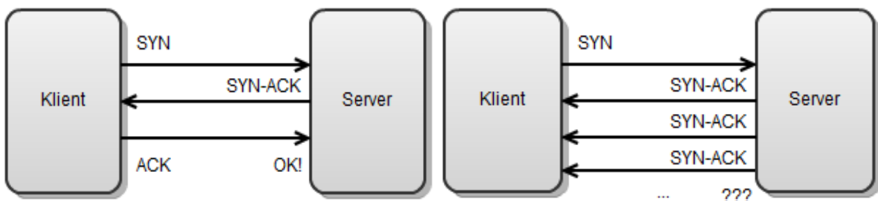
Bild 3: En visuell presentation över en lyckad TCP-anslutning (vänster) och ett TCP-angrepp (höger). Angreppet fungerar på så sätt att serverns SYN-ACK meddelande inte besvaras. Väntekön kommer att fyllas med sådana väntande anslutningar, och legitima användare kommer inte att kunna nå tjänsten.
